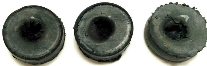
3.30 Сурет – Үлгілер \text{CaCl}_2 ерітіндісінде 5 тәулік ұсталғаннан кейін (кесу арқылы тозу)
