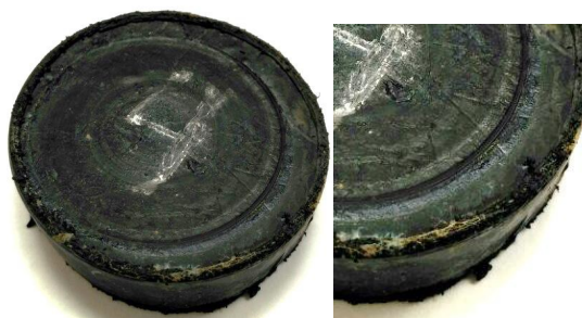
3.18 Сурет – KCl ерітіндісінде 15 тәулік ұсталғаннан кейін үлгі (үйкеліспен тозу)
