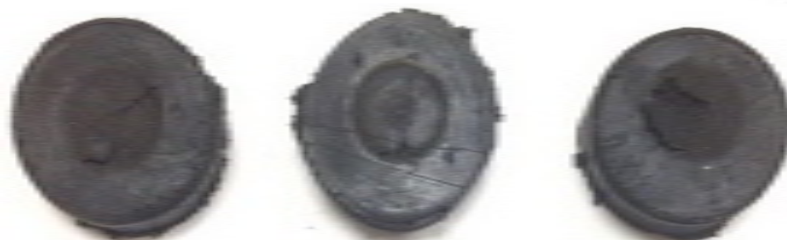
3.26 Сурет – MgCl_2 ерітіндісінде 15 күн ұсталғаннан кейін үлгілер (кесу арқылы тозу)
