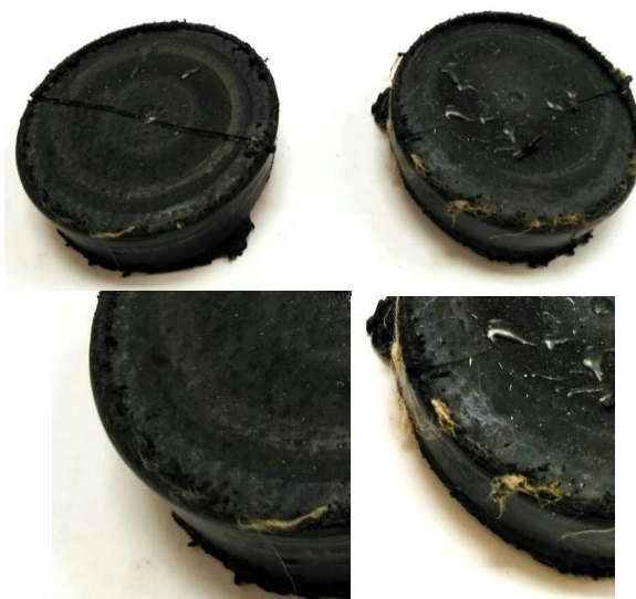
3.21 Сурет – MgCl_2 ерітіндісінде 5 күн ұсталғаннан кейін үлгілер (үйкеліспен тозуы)
