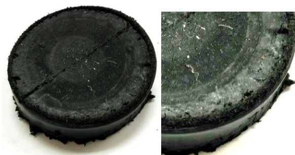
3.23 Сурет – MgCl_2 ерітіндісінде 10 күн ұсталғаннан кейін үлгі (үйкеліспен тозуы)
