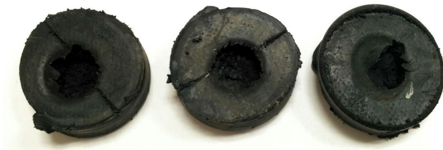
3.15 Сурет – Үлгілер KCl ерітіндісінде 5 тәулік ұсталғаннан кейін (кесу арқылы тозу)
